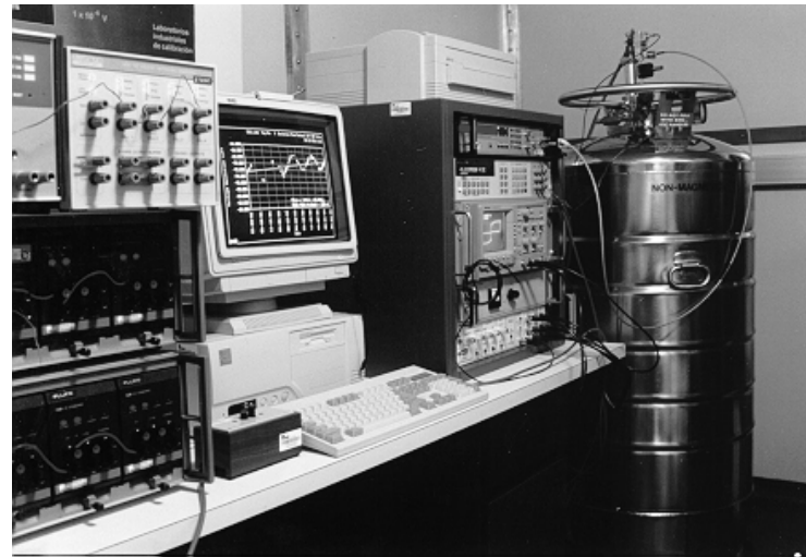
Laboratorio de patrón de tensión del CENAM, donde se mantiene en operación el efecto Josephson.
