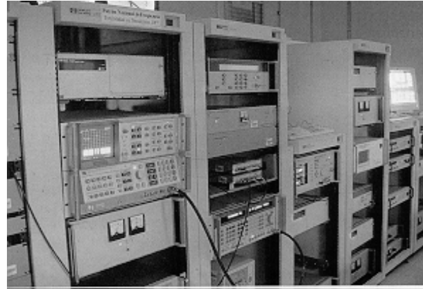
Laboratorio de relojes atómicos del CENAM, donde se mantienen en operación los Patrones Nacionales de Tiempo y Frecuencia.
